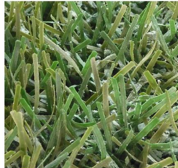
Nach 480.000 Lisport-Zyklen noch keine Beschädigungen der Faser erkennbar
