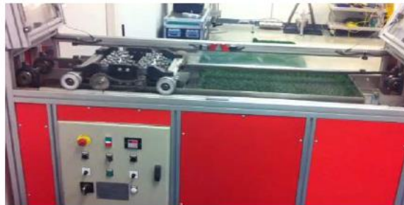
Lisport: Stresstest gegen mechanische Beanspruchung
